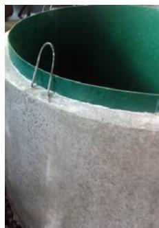
Полимерный футеровочный лист с анкерными элементами для защиты бетонных поверхностей от коррозии, изнашивания и временных разрушений. Создает полную герметизацию труб, колодцев и других различных резервуаров за счет сварки стыков экструзией.
